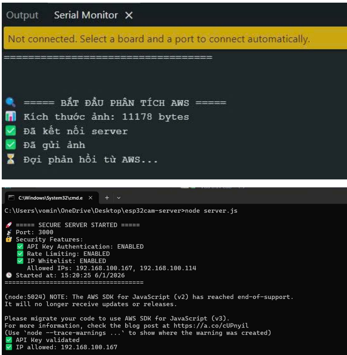
Hình 4.4 : ESP32-CAM gửi HTTP POST request và server xác thực API Key, IP Whitelist và Rate Limiting
